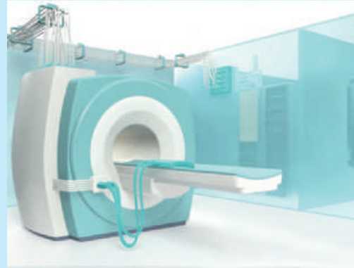
Otro equipo de RM: digitalización lejos de la bobina
